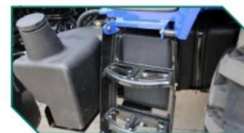
O grande tanque de combustível de 120 L pode garantir que o trator trabalhe em carga máxima por 10 a 14 horas, reduzir o tempo de reabastecimento e melhorar a eficiência do trabalho; Levante de alta pressão, força de elevação de até 24 kN, lidando facilmente com
